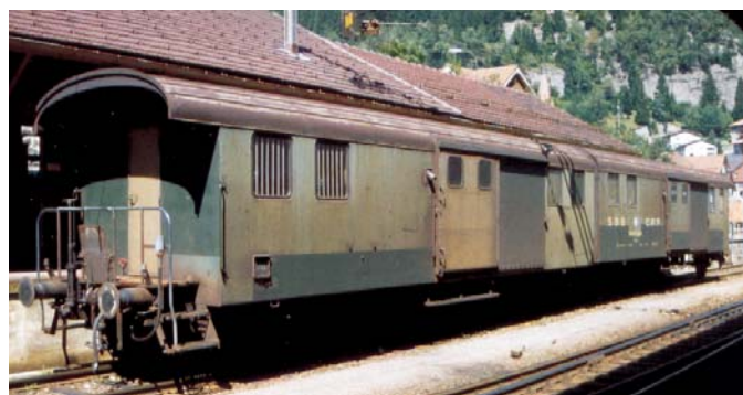
31716 new 03-2009 SBB Sortierwagen D2-D2 50 85 93-33 000-034. Baujahr 1962-1963. Zweiteilige Einheit kurzgekuppelt. Geripptes Dach, Fenstergitter. Stirntüre alu. Epoche IV.
