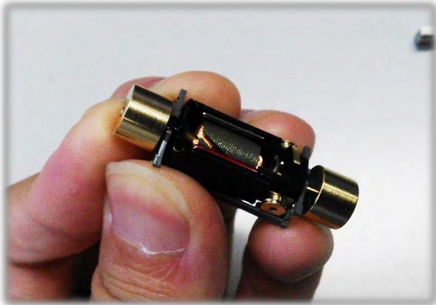
Zur einfachen Entfernung der grauen Halterung drücken Sie die beiden Laschen leicht zusammen (s. Bild).
